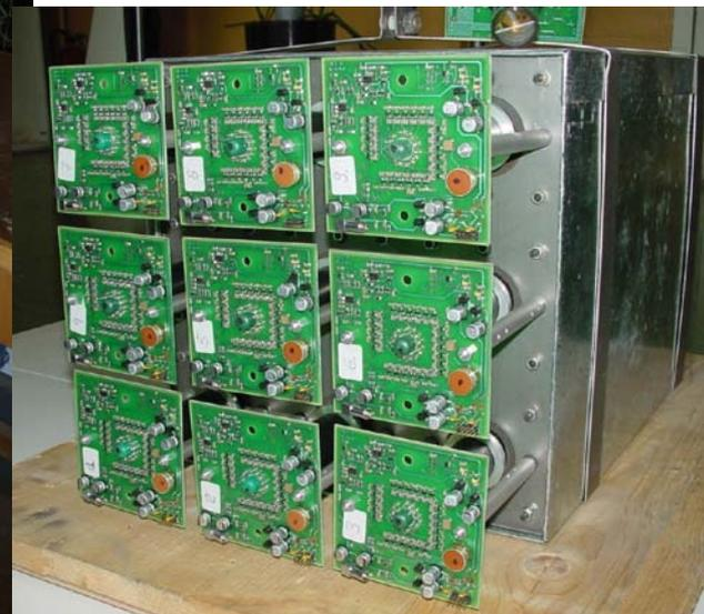
**Лабораторный макет калориметра из 9 модулей.**
